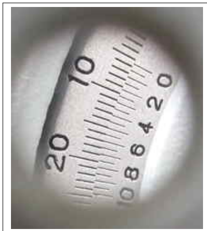
Abbildung 3: Winkelskala und Noniusskala des in diesem Versuch verwendeten Polarisimeters.
