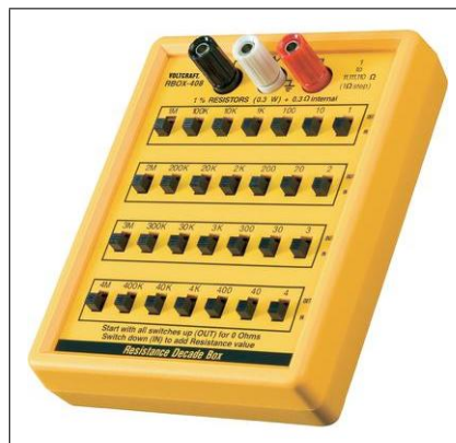
Abbildung 1: Voltcraft R-Box 01 als Dekadenwiderstand. Die rote und schwarze Buchse werden als Anschlussbuchsen verwendet, mit diesen wird die Solarzelle verbunden. Widerstände werden durch Betätigen der Schalter zugeschaltet, so dass sich ein variabler Lastwiderstand ergibt. Messen Sie stets von großen zu kleinen Widerständen.
