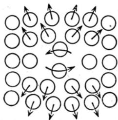
Abb. 1. „Platztausch“ in einem aufgelockerten Gitterbereich (Barrer 1941).
